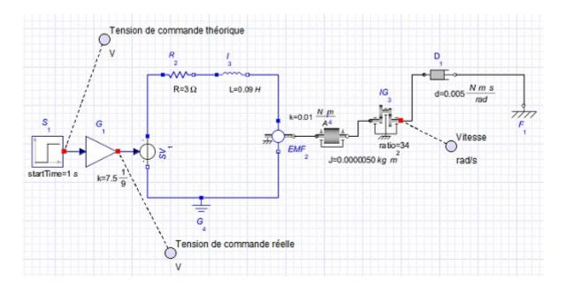
La simulation de ce modèle soumis à un échelon de tension de 6V théorique donne les résultats suivants :
