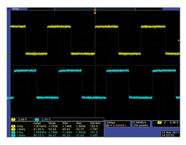
Ces deux signaux permettent de mesurer à la fois la vitesse et le sens de rotation. La mesure de la vitesse se fait simplement en comptant le nombre d'impulsions pendant un temps fixe. Les données du problème sont les suivantes :
